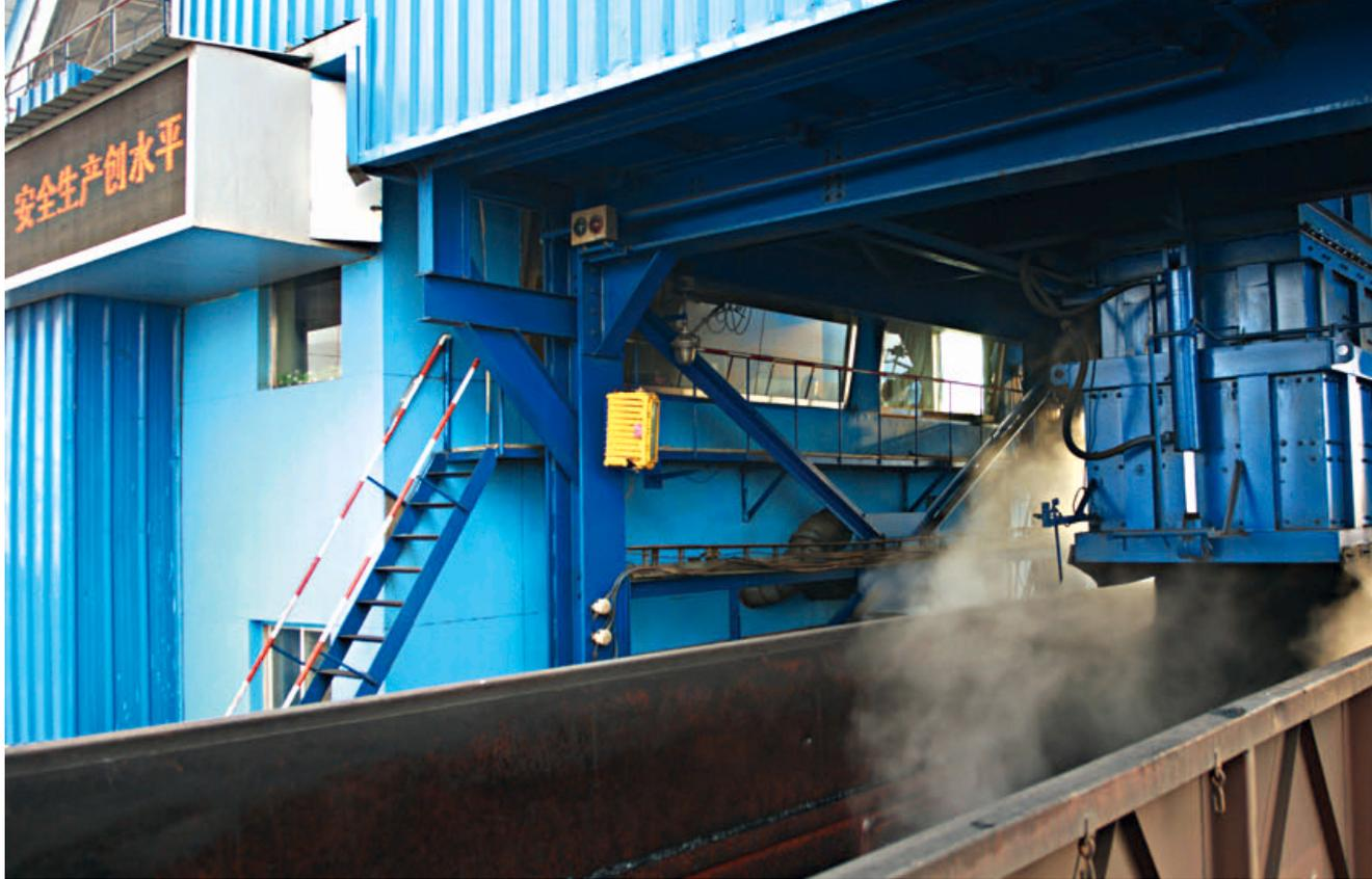
自動化封閉煤炭裝車系統
