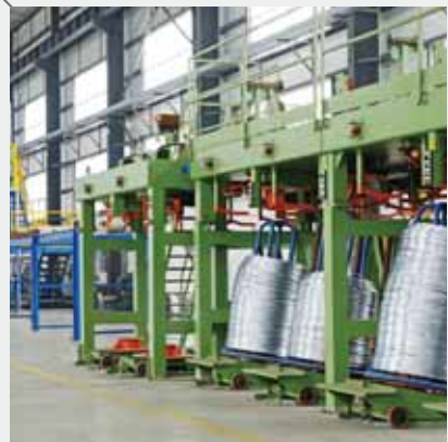
位於中國廣東鶴山之鍍鋅鋼絲生產線
