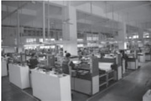
各種切割機、注塑機及修切機將原材料裁剪及修整為所需的形狀與呎吋。
