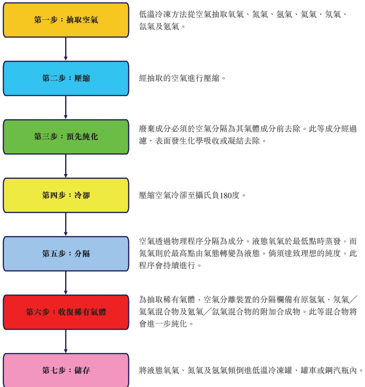
我們使用空氣分離裝置作為生產工業氣體過程中的核心設備。典型空氣分離裝置的主要零部件包括：空氣過濾器、空氣壓縮器、冷凍裝置、分子過濾純化器、電力加熱器、熱交換器、渦輪擴張器、精餾欄、副冷卻器、氧氣儲存器、氧氣壓縮器及氧氣補給系統。
