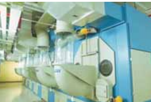
新中國洗衣引入真空輸送系統以縮短乾衣時間，以及降低熱氣排放
