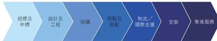
自合同招標及中標起至安裝建築物外牆產品的整個過程一般需耗時18個月至兩年時間。該時段視多項因素而有所不同，該等因素包括建築物外牆面積的規模、幕牆系統的技術特色及複雜度、建築物的施工進度、物業發展商指定的時限及自有關建設當局取得設計圖紙批准及同意的時間。設計、工程及測試階段一般耗時六至九個月。接下來兩至三個月的工作將會涉及材料採購、在深圳生產設施預製及裝配該等材料，並將預製好的產品交付至各個項目施工工地。安裝需時約九至十二個月，之後項目方會竣工並移交予客戶。
