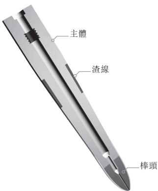
塞棒由主體、渣線及棒頭三部份組成，屬重要的鋼流調控組件之一。由於塞棒將熔鋼引導流往結晶器，其承受激烈的溫度衝擊。塞棒棒頭須特別設計以防止熔鋼沖蝕。由於塞棒浸於中間包內，其渣線必須能抵禦中間包覆蓋劑可能引起之化學侵蝕。此外，為
