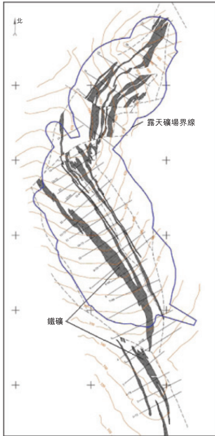
圖3.4：中區擬建礦場略圖中 Kimkan 主要礦體的簡明地質結構
