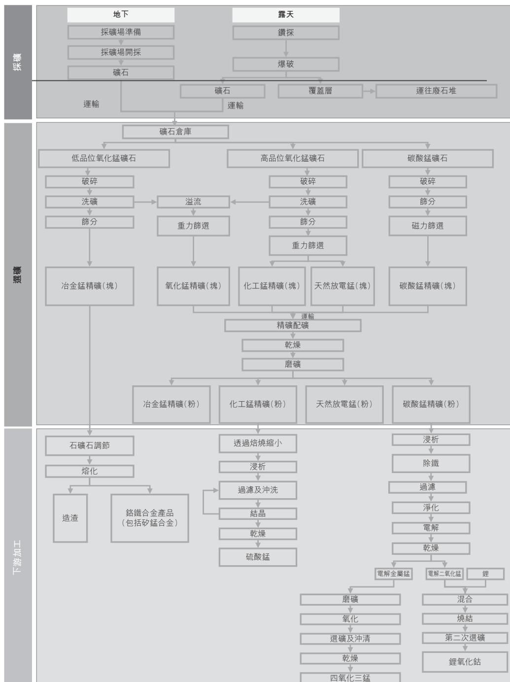
大新錳礦及天等錳礦於經營期間所進行的採礦構成我們的上游營運。礦石加工構成中游營運，於此過程中原礦被洗淨、篩選及集合以製成塊狀，塊狀再被磨成精礦粉末。下游營運
