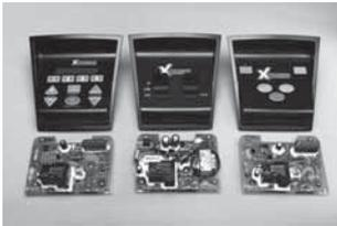
工業級別攪拌機控制面板的控制模組。
