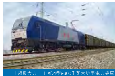
「超級大力士」HXD1型9600千瓦大功率電力機車
