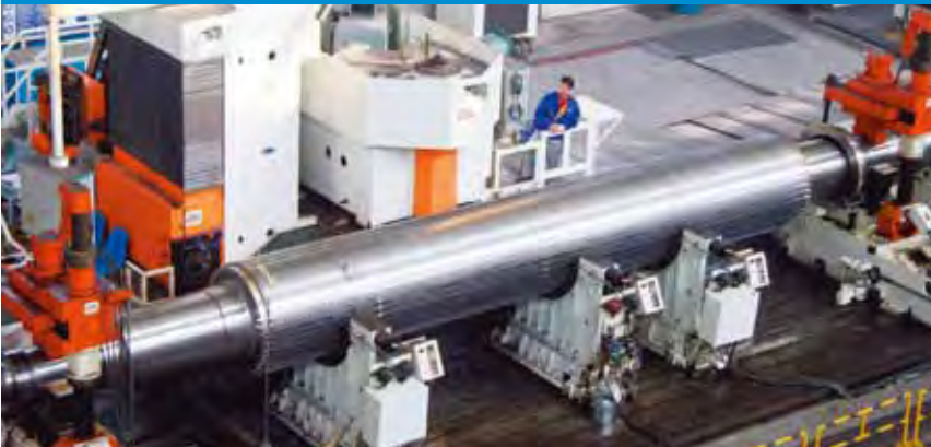
百萬千瓦級發電機轉子加工中
