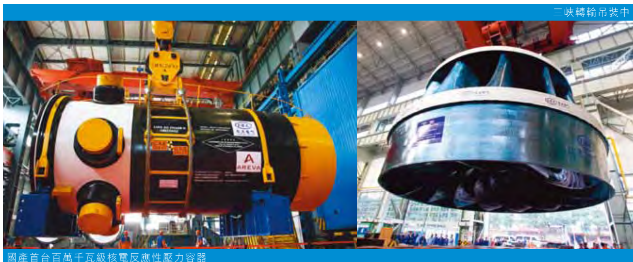
國產首台百萬千瓦級核電反應性壓力容器
