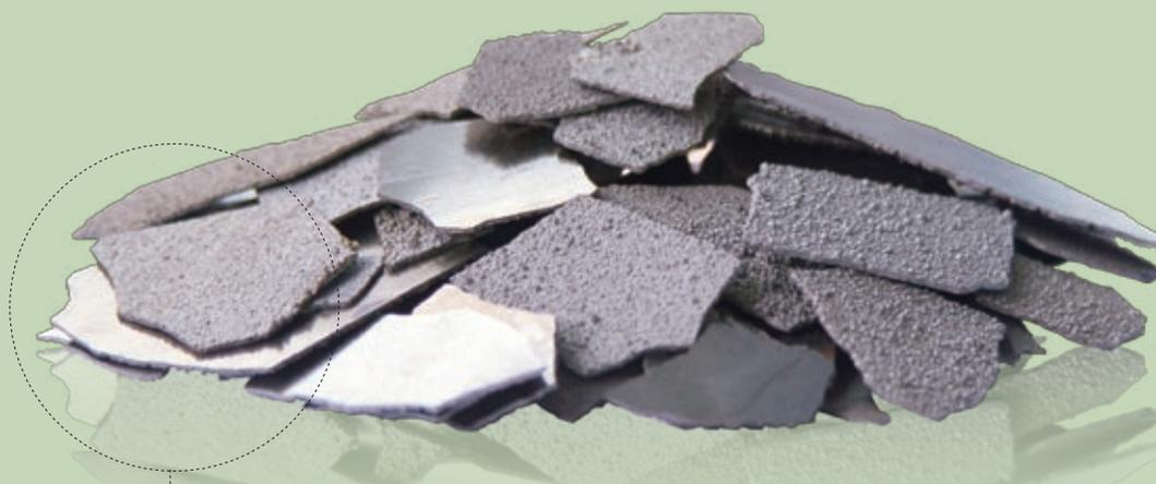
錳是製造鋼材的必要原料。錳在製鋼過程中能消除硫及氧等雜質，並透過改善強度、硬度以及抗磨損度，從而改善鋼的物理特質。錳亦改善鋼的滾動質素及鍛造質素以及焊接力。由於錳並無現成的替代品，預期錳於鋼業之用途將會繼續。
