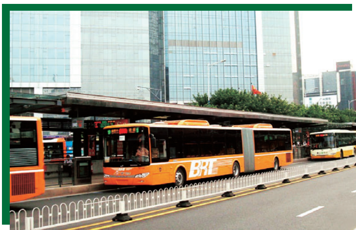
廣州市第二巴士在「快速公交」(BRT) 通道內運營的18米加長型空調大巴，每輛載客150至200人，可極大舒緩高峰期的繁忙人次。
