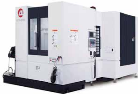
本集團台灣研發中心研發的HT630臥式雙工作台CNC加工中心
