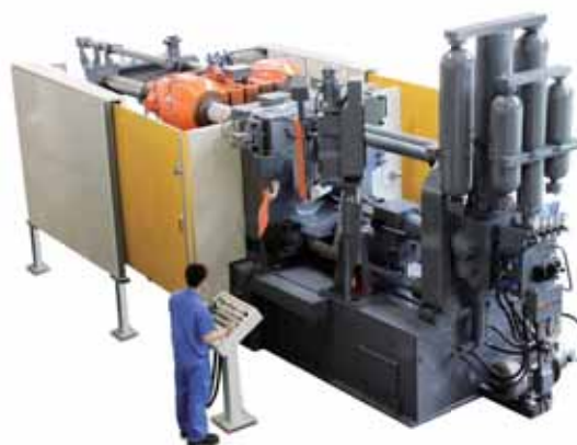
本集團研發的國內首台900噸兩板式伺服節能壓鑄機
