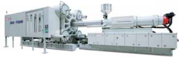
本集團生產的3,000噸大型兩板式注塑機
