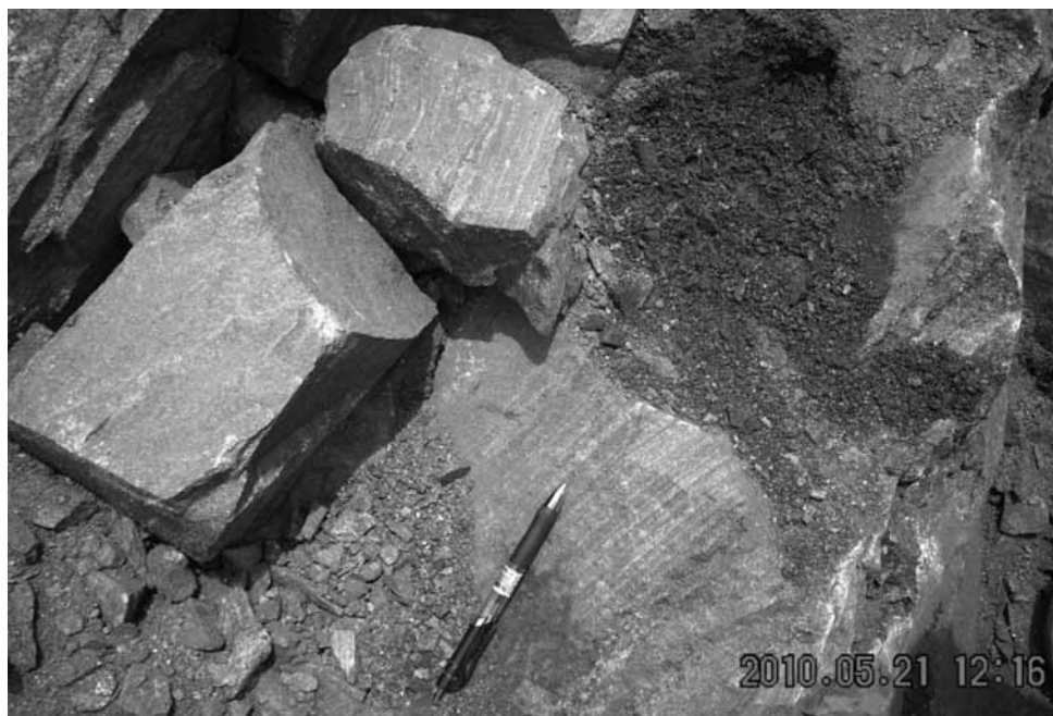
圖4-10:毛公礦礦石的典型帶狀結構
