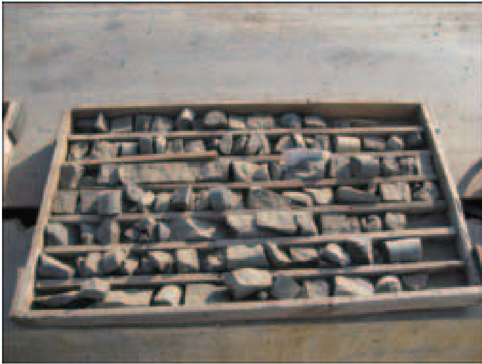
圖8-12：來自ZK100-1的鑽孔岩芯(548.60-550.50米)
