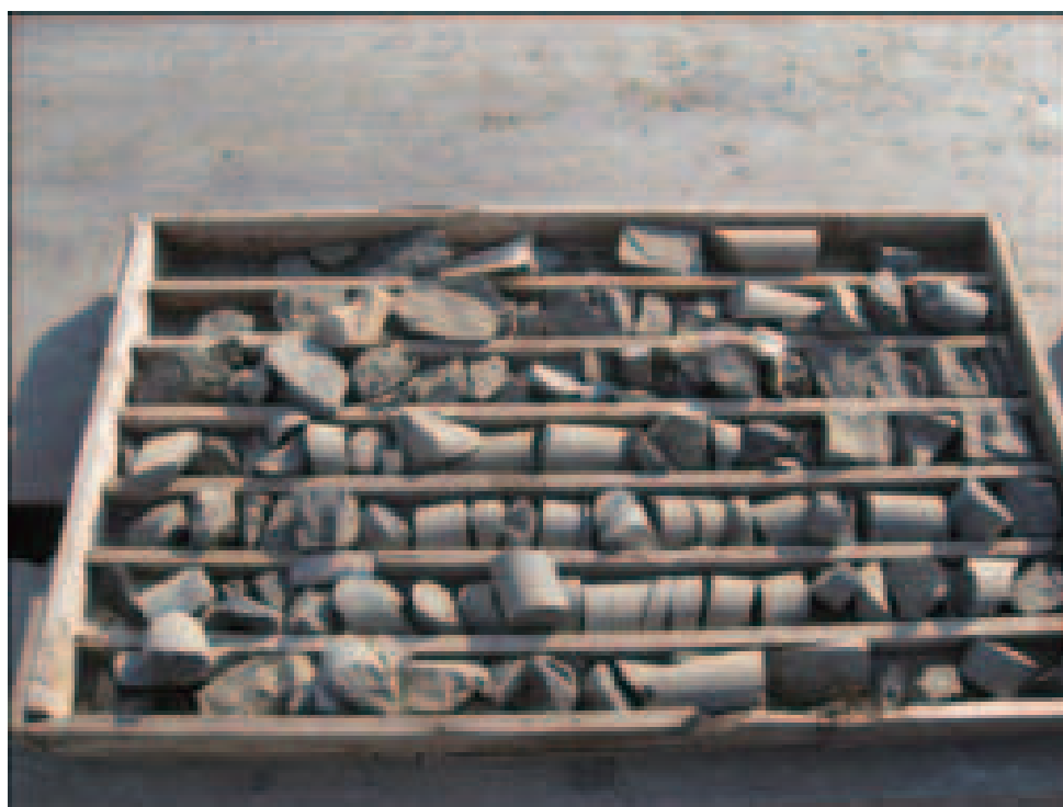
圖8-11:來自ZK130-1的鑽孔岩芯(197.60-199.60米)
