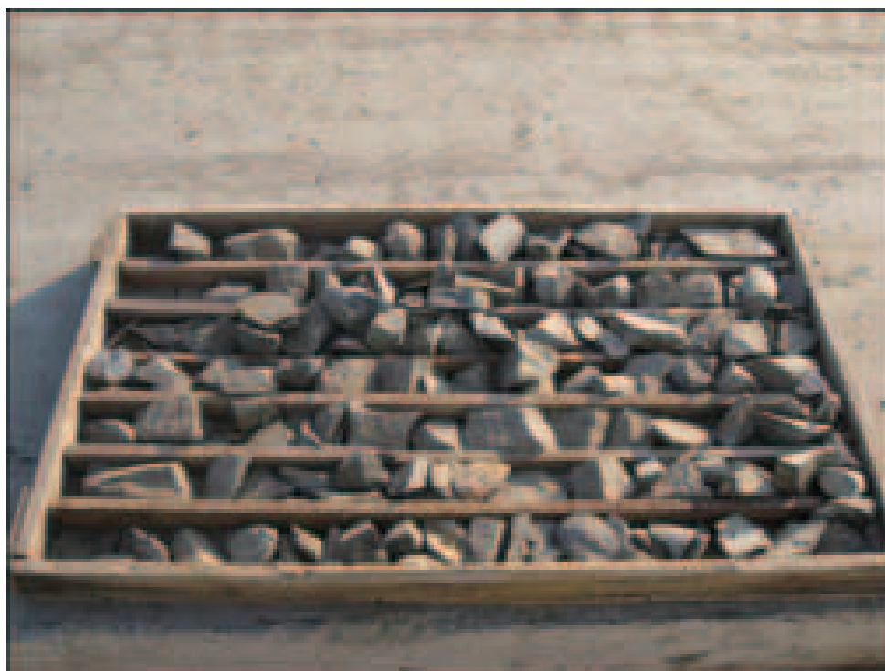
圖8-16：來自ZK118-1的鑽孔岩芯(173.00-175.90米)
