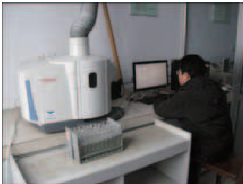
圖8-9：技術人員在日照重點實驗室操作的ICP-OES機器
