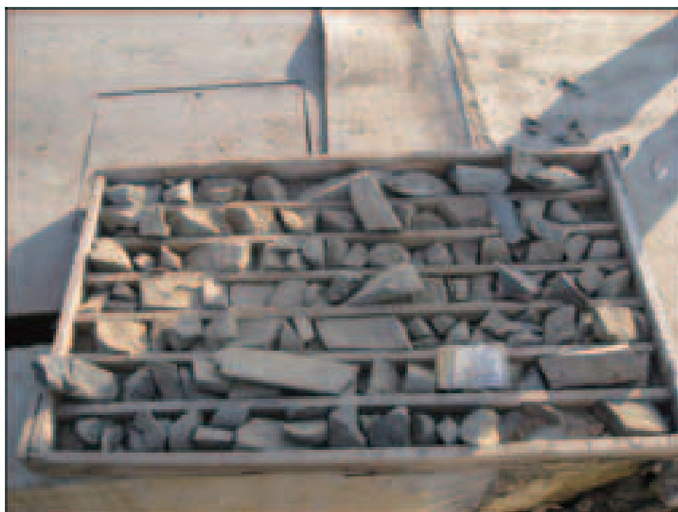
圖8-16：來自ZK118-1的鑽孔岩芯(173.00-175.90米)
