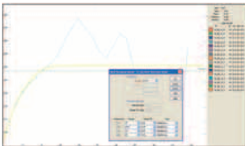
圖11-33：南部礦體二氧化鈦的連續性第二方向的半方差模型
