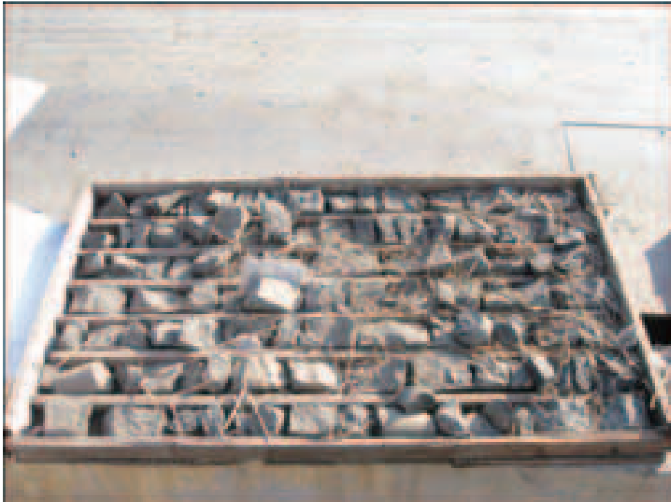
圖8-12：來自ZK100-1的鑽孔岩芯(548.60-550.50米)
