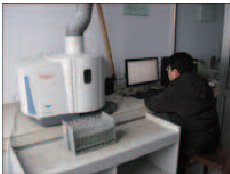
圖7-9：技術人員在日照重點實驗室操作的ICP-OES機器
