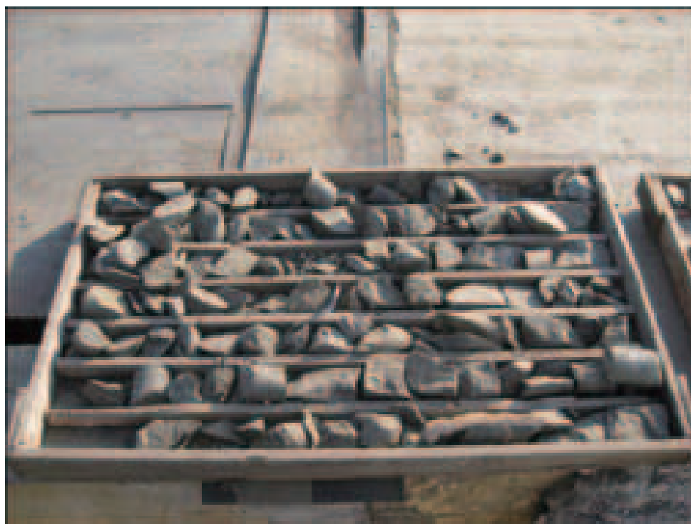
圖8-14：來自ZK114-2的鑽孔岩芯(140.20-142.40米)
