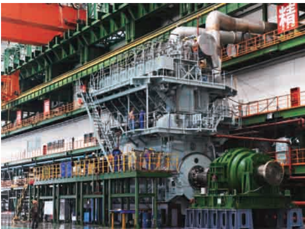
集團柴油機成品需進行試驗，確保各種污染物排放量合乎標準
