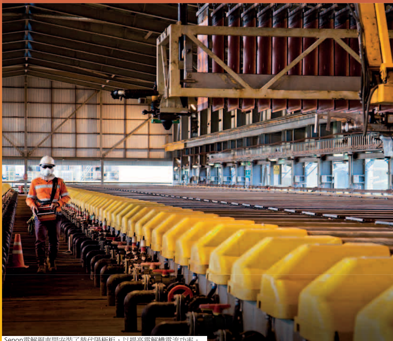
Sepon 電解銅車間安裝了替代陽極板，以提高電解槽電流功率。
