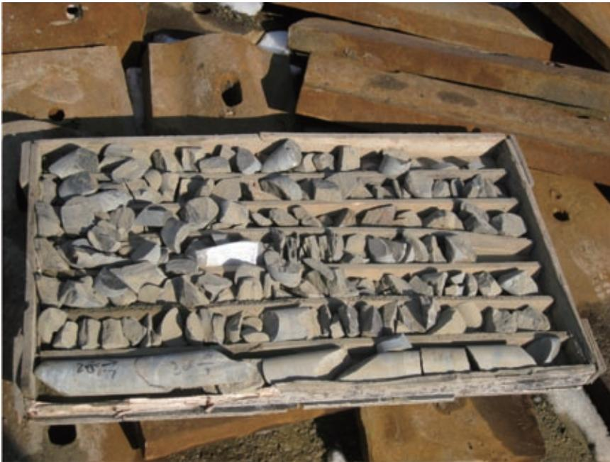
圖7-12：ZK44-2孔的鑽孔岩芯(488.80-491.20米)
