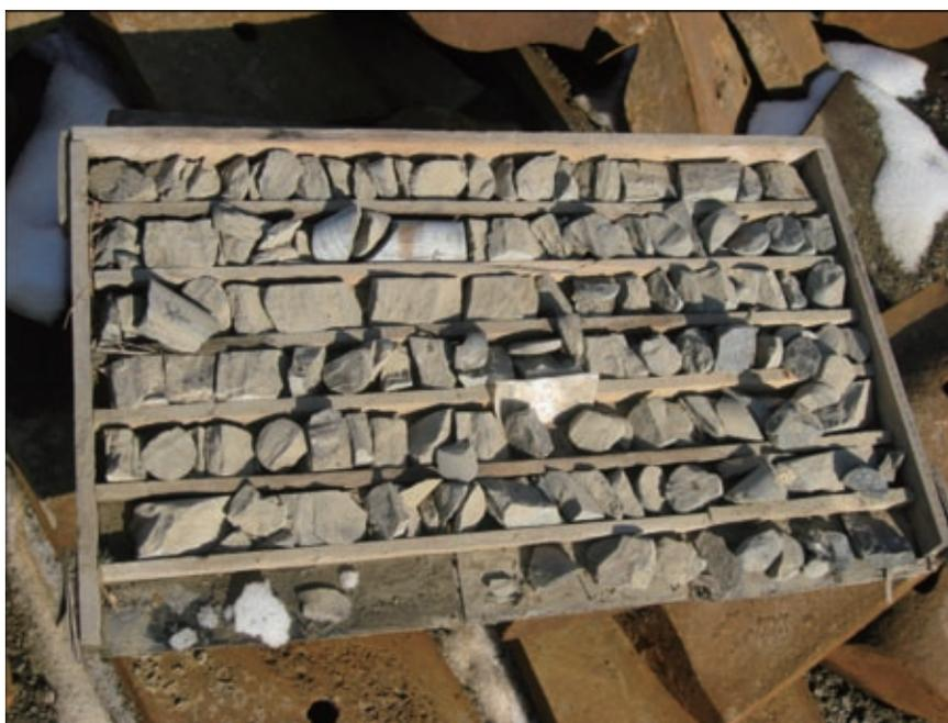
圖7-14：ZK20孔的鑽孔岩芯(121.50-126.30米)
