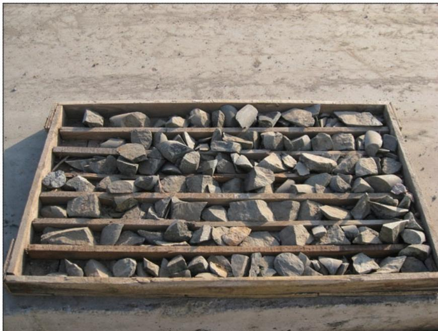
圖8-16：來自ZK118-1的鑽孔岩芯(173.00-175.90米)
