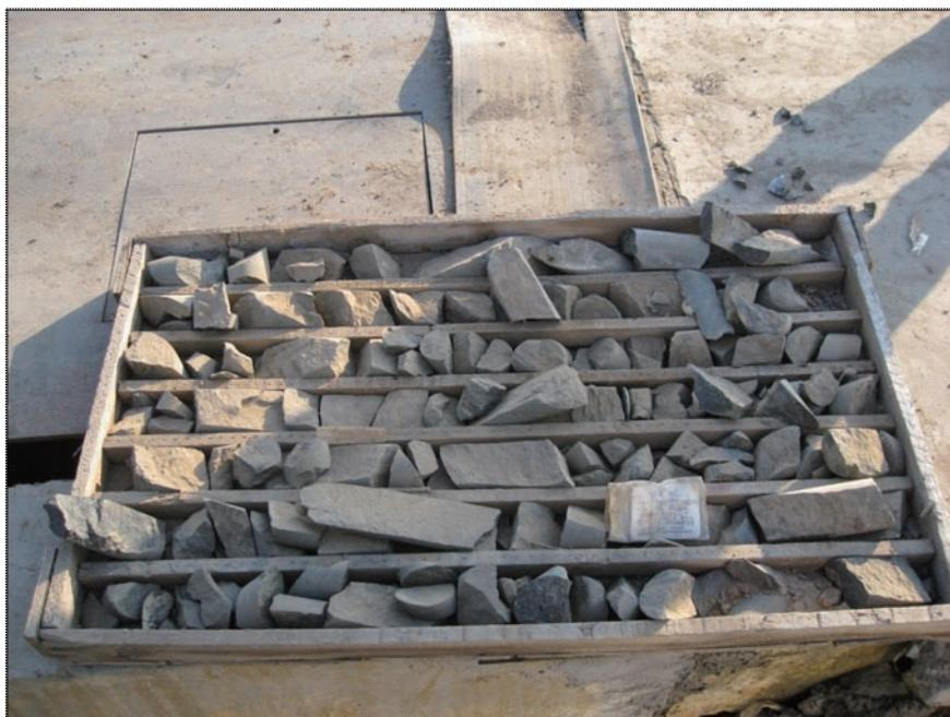
圖8-17：來自ZK114-1的鑽孔岩芯(69.60-71.10米)
