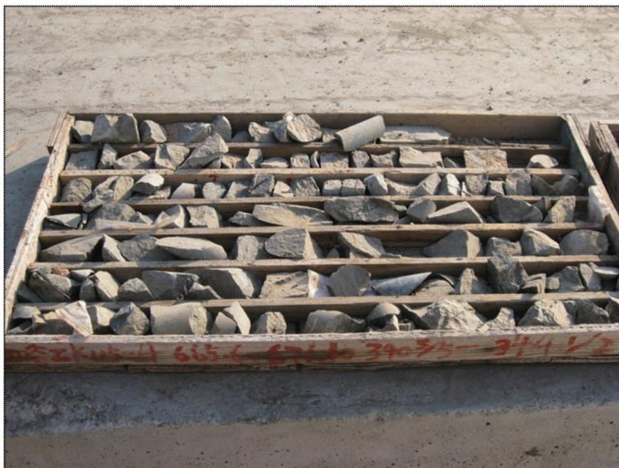
圖8-15：來自ZK115-4的鑽孔岩芯(666.60-667.50米)
