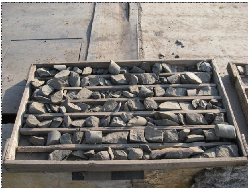
圖8-14：來自ZK114-2的鑽孔岩芯(140.20-142.40米)
