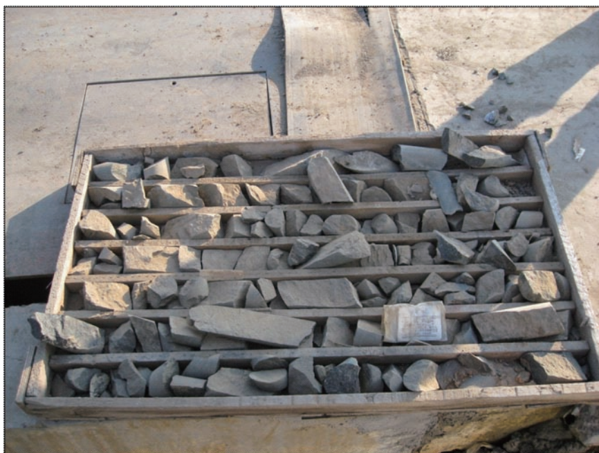
圖8-16：來自ZK118-1的鑽孔岩芯(173.00-175.90米)
