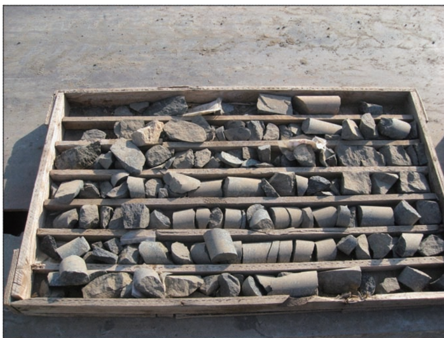
圖8-11：來自ZK130-1的鑽孔岩芯(197.60-199.60米)
