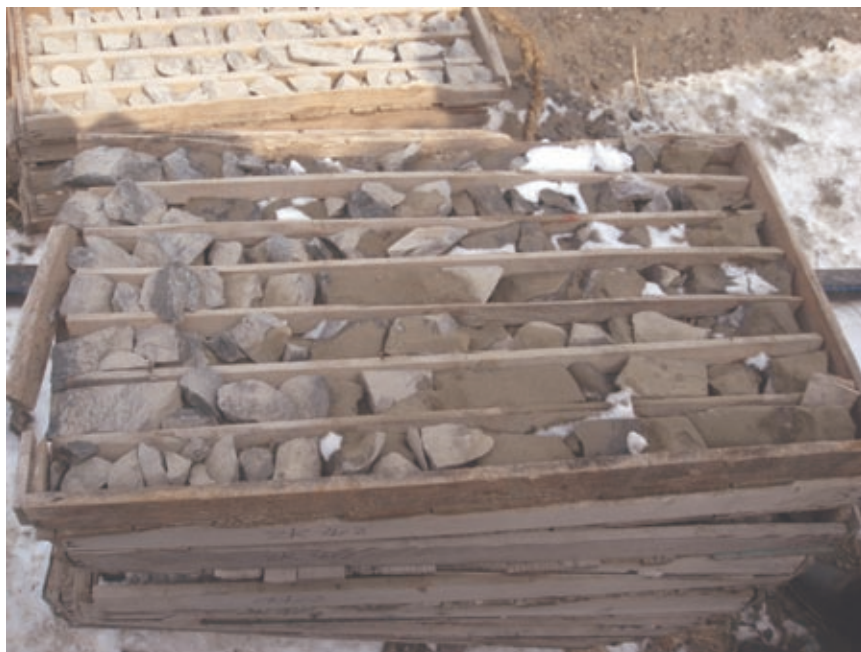
圖7-13：來自ZK402的鑽孔岩芯(161.80-163.80米)
