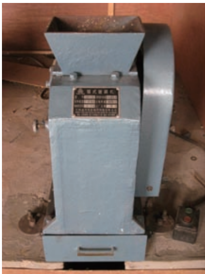
圖8-6：第一階段的鄂式破碎機（左）及第二階段的冷式破碎機（右）
