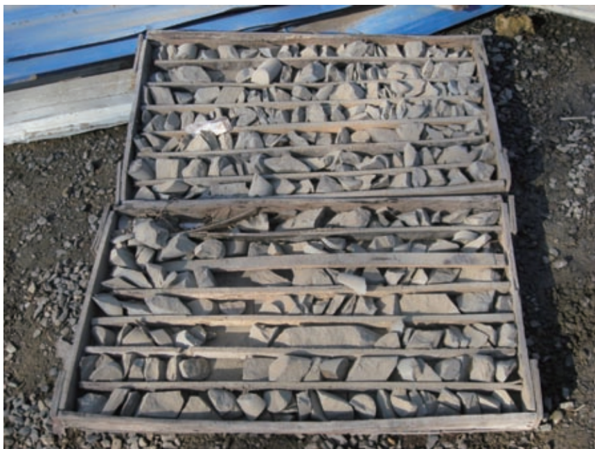
圖7-13：ZK33-1孔的鑽孔岩芯(339.84-341.84米)
