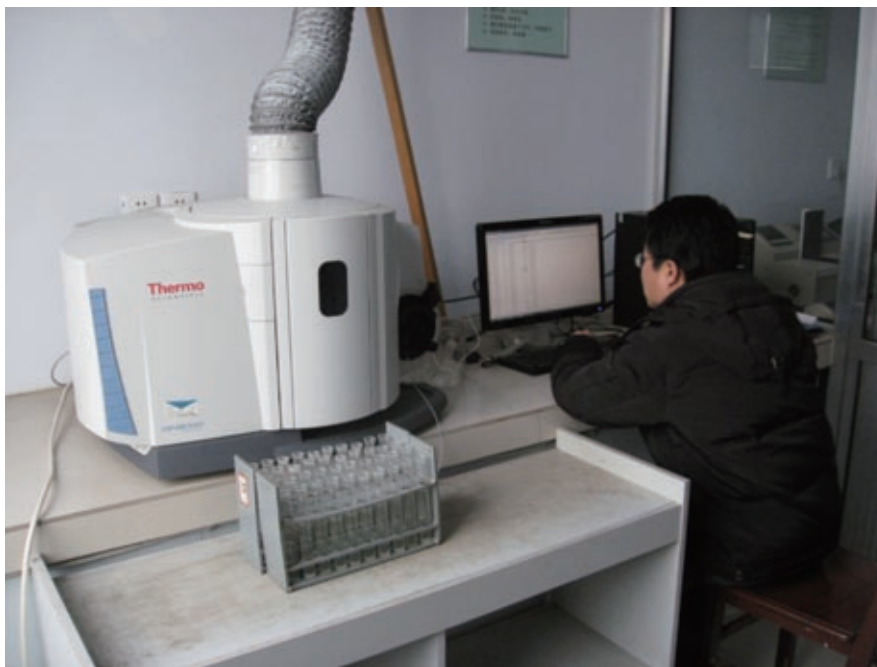
圖8-9：技術人員在日照重點實驗室操作的ICP-OES機器
