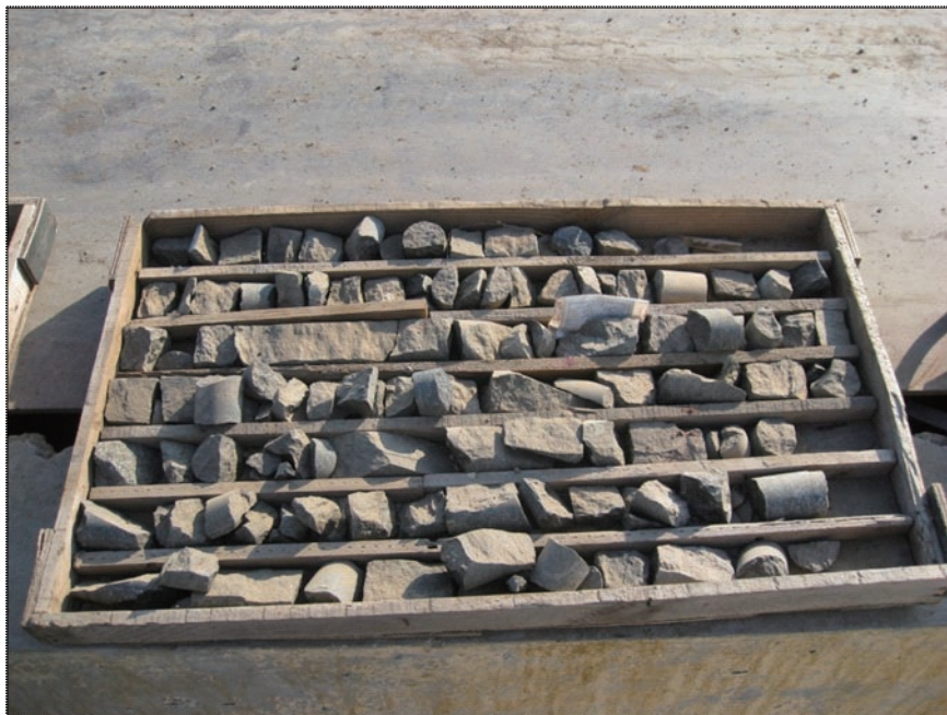
圖8-12：來自ZK100-1的鑽孔岩芯(548.60-550.50米)
