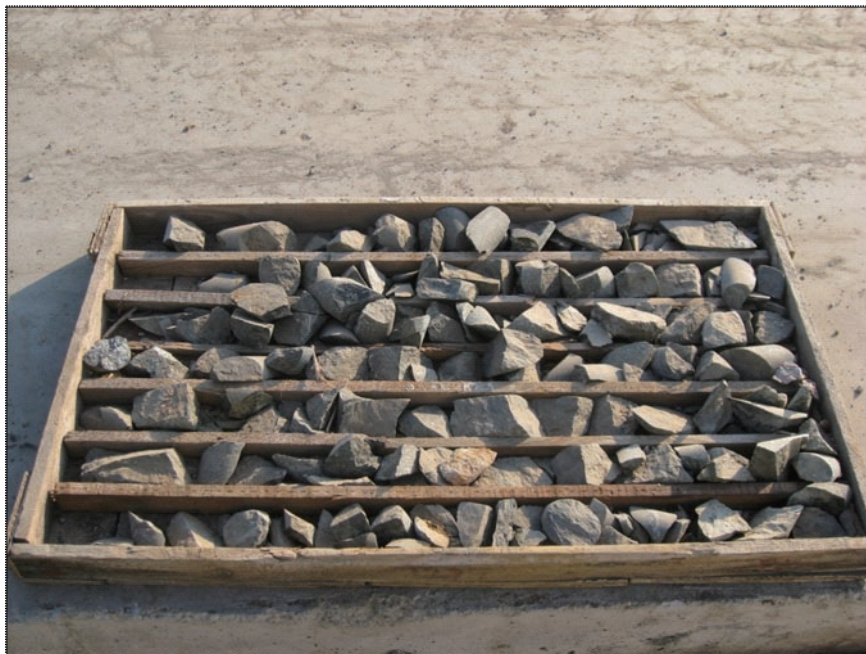
圖8-16：來自ZK118-1的鑽孔岩芯(173.00-175.90米)
