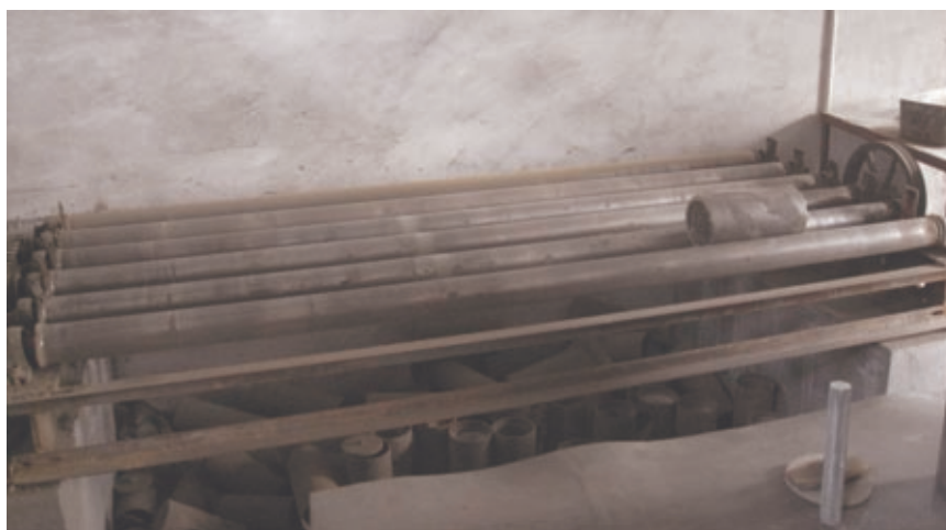
圖7-6：第一階段的鄂式破碎機（左）及第二階段的冷式破碎機（右）
