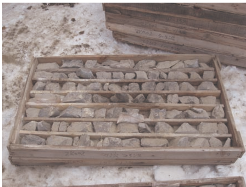
圖7-12：來自ZK102的鑽孔岩芯(46.30-49.15米)
