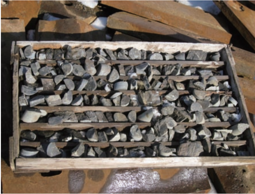
圖7-11：ZK37-1孔的鑽孔岩芯(370.50-373.50米)
