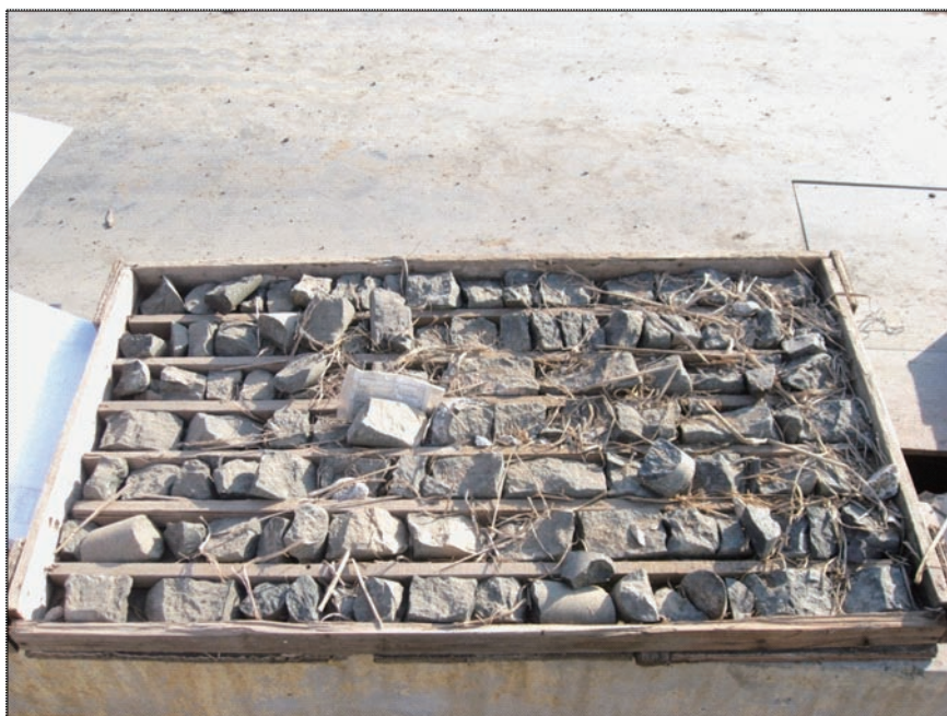
圖8-12：來自ZK100-1的鑽孔岩芯(548.60-550.50米)
