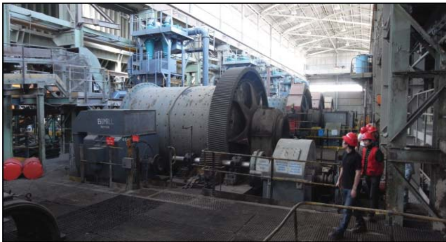
圖8-13：Baluba 選礦廠的球磨機
