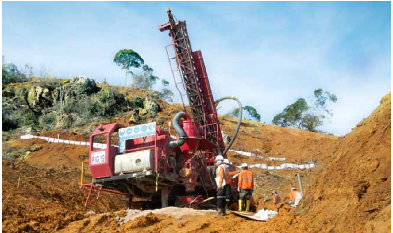
藉反循環鑽探進行品位控制鑽探。
