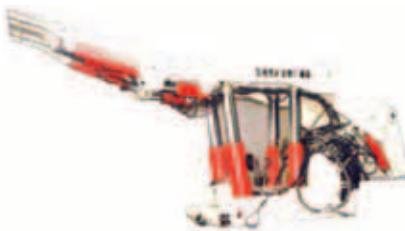
端頭液壓支架 ..... 該產品用於支撐工作面端頭巷道頂板，並配備推移運輸機和轉載機。
