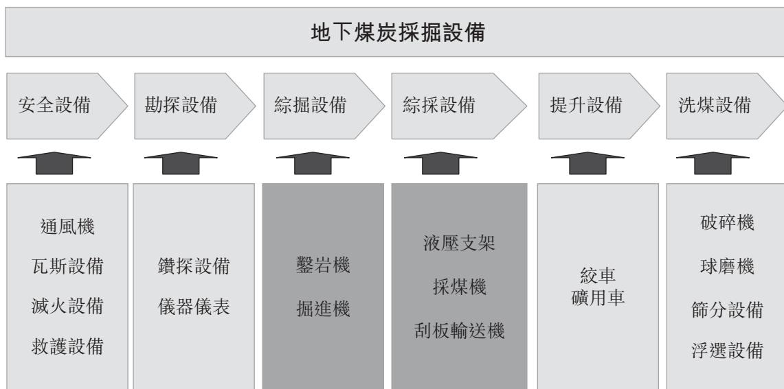
在一般行業術語及本文件的文義下，煤炭採掘設備一般指液壓支架、採煤機、刮板輸送機及掘進機，亦合稱為「三機一架」。
