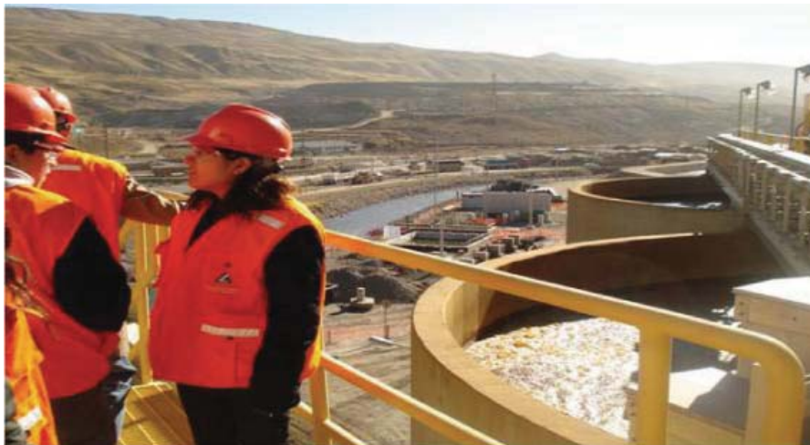
圖13.5. 金斯米爾隧道污水處理廠設施 (建設優良、運行良好，可處理 Toromocho 山頂地區以往的礦山排水，為新採礦項目提供加工用水)
