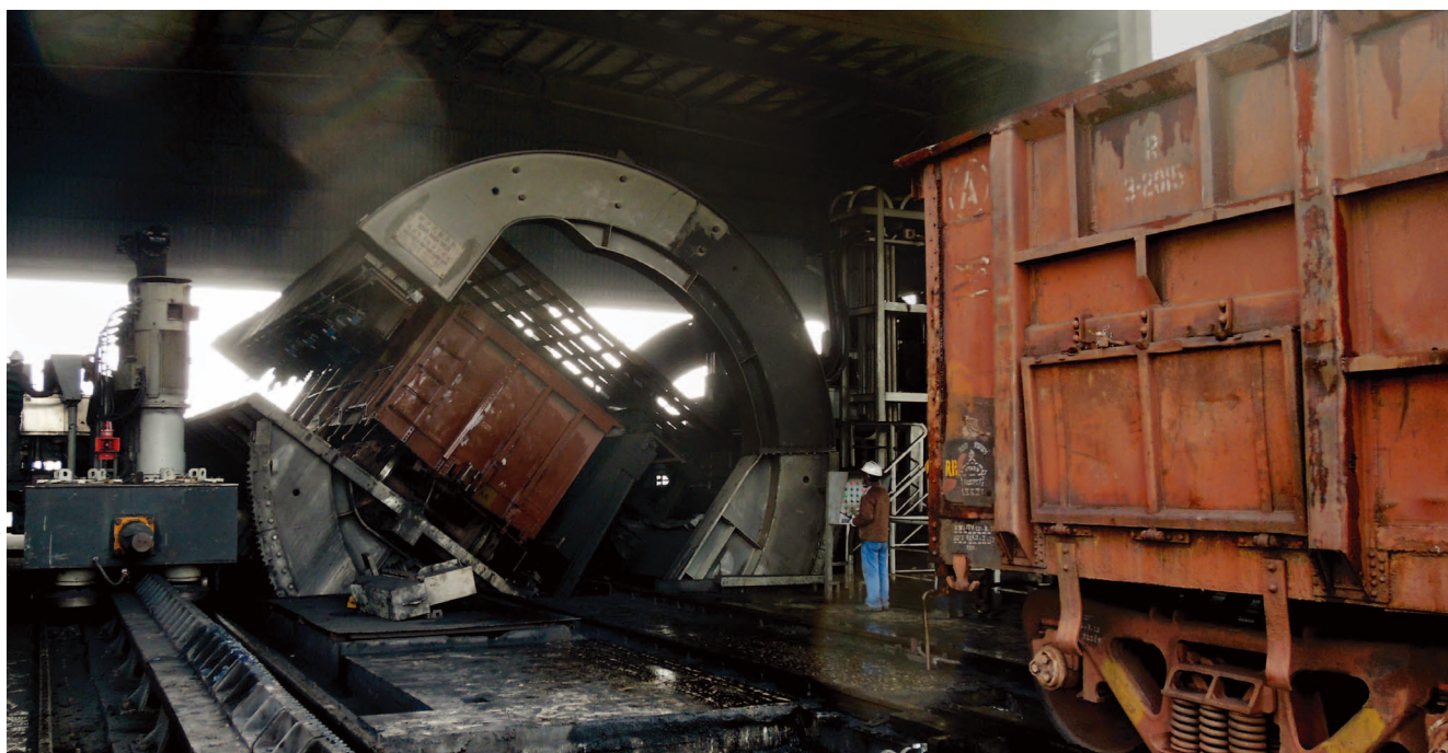
哈格爾電廠的卸煤裝置 — 我們須於五小時內從約60卡的火車卸下燃煤
