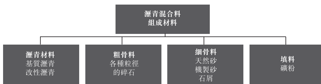
圖13 瀝青混合料的組成材料
