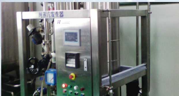
設備名稱：純蒸氣發生器 作用：供應純蒸氣予各相關機組
