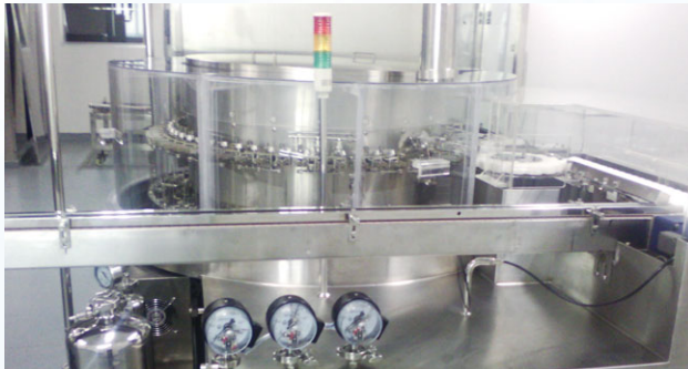
設備名稱：醫療級藥瓶清洗機 作用：徹底清洗藥瓶
