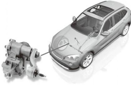
轉向管柱把方向盤連接至轉向機械，並透過從方向盤傳遞駕駛員選擇的扭力，控制轉向。
