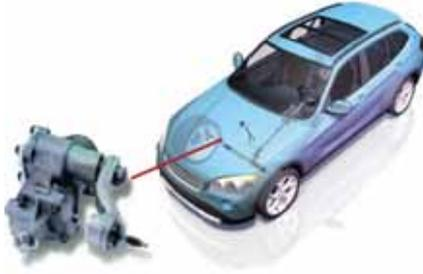
轉向管柱把方向盤連接至轉向機械，並透過從方向盤傳遞駕駛員選擇的扭力，以控制轉向。
