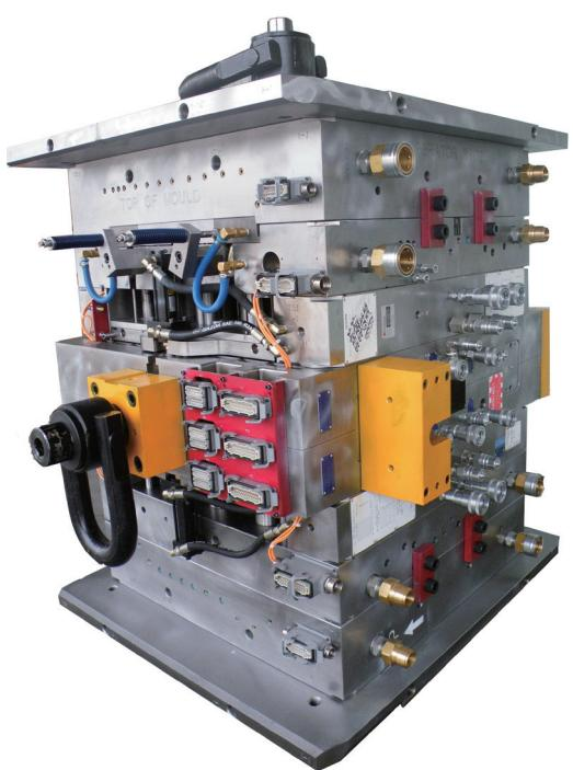
根據Ipsos報告，標準模具的尺寸較大、型腔數目較少、結構設計較複雜，且每個模具擁有相對較多數目的部件。我們的標準模具用於製造各類產品（包括門板、手套箱及格柵等汽車部件、會議電話終端機等商業誦訊設備以及洗衣機及冰箱等家用電器）的注塑組件。
