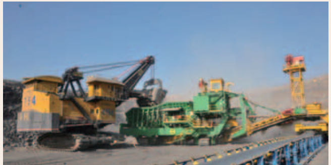
平朔公司半连续工艺设备
