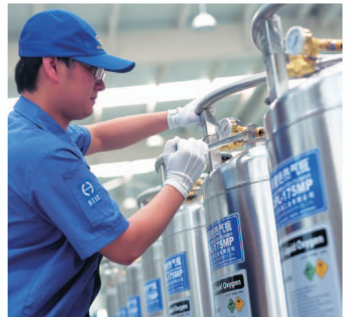
工作人員檢修焊接絕熱氣瓶
