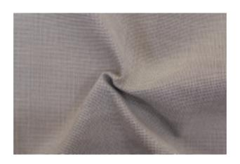
此系列面料透過採用不同厚度及長度的竹節紗交替經緯紡織而成,其中使用不同織物結構形成不同樣式的面料。此系列適合用作戶外沙灘褲、戶外恤衫及休閒短褲的面料。
