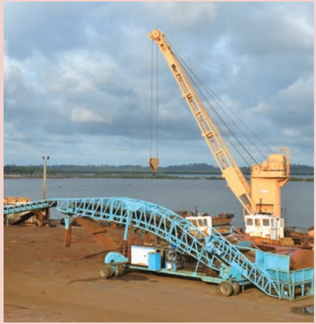
皮帶輸送機把錳精礦輸送到散裝船載運出口
