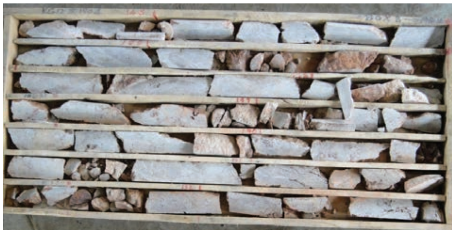
圖7-13：鑽孔ZK1904的鑽孔岩芯間隔（145米至152米）
