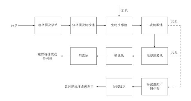
城鎮污水通常含有磷及有機物,於排放入環境前一般需經過物理、生物及化學工序處理。不同地區城鎮污水所含污染物的性質及數量差異極大。因此,我們根據對以下各項因素的分析採用不同工序處理城鎮污水:(i)污水的成分;(ii)經處理污水將達到的標準;(iii)待處理的污水量;及(iv)建設條件及對周邊環境的影響。可綜合應用不同技術以盡量提高處理效果及降低處理成本。我們的污水處理工序一般涉及以下階段:
