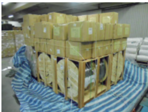
上圖顯示重量小／體積小的貨物裝在重量大／體積大的貨物上進行拼箱。
