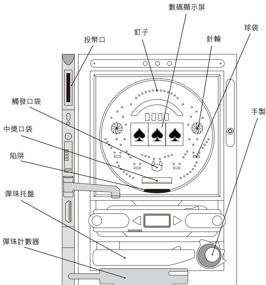
日式彈珠機有如垂直放置的彈球機(但並無彈珠台而僅有大量彈珠)。遊戲目的在於贏取盡可能多的彈珠以換取我們遊戲館的獎品。於遊戲機旁邊的投幣口投入現金、插入預付IC卡或會員卡後，會有小鐵彈珠瀉入遊戲區下方的彈珠托盤。玩家向遊戲區快速連續發射彈珠，並通過轉動托盤旁的手掣控制彈珠的發射速度。準確掌握恰當的發射力度是遊戲取勝的關鍵，手掣轉動幅度過大，彈珠會直接滾落出口槽，並被沒收；手掣轉動幅度過小，彈珠則無法射入遊戲區。
