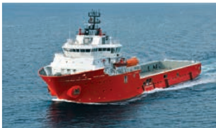
於二零一四年引入的L級船隻，是具燃油效益、適合深水作業的大型平台補給船。
