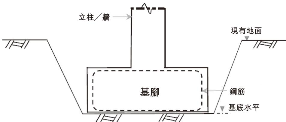
樁帽是建於一根樁柱或一組樁柱頂部的混凝土結構，以轉移上層結構負荷，即從立柱或牆至樁柱。倘需要，樁帽會建於一組樁柱頂部，以便各樁柱間分擔負荷。樁帽的另一功能是(其中包括)調節樁柱原定位置的偏差。基腳與樁帽的區別在於基腳直接將負荷轉移至床岩，而樁帽則將負荷轉移至樁柱。
