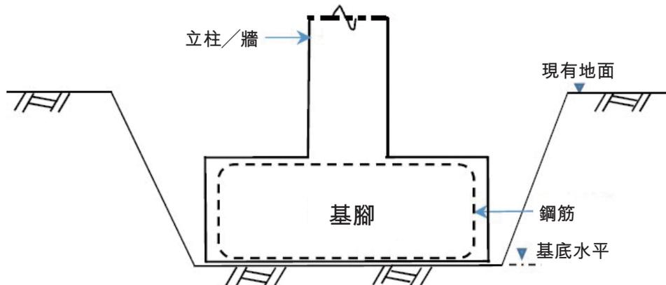
樁帽是建於一根樁柱或一組樁柱頂部的混凝土結構，以轉移上層結構負荷，即從立柱或牆至樁柱。倘需要，樁帽會建於一組樁柱頂部，以便各樁柱間分擔負荷。樁帽的另一功能是(其中包括)調節樁柱原定位位置的偏差。基腳與樁帽的區別在於基腳直接將負荷轉移至床岩，而樁帽則將負荷轉移至樁柱。
