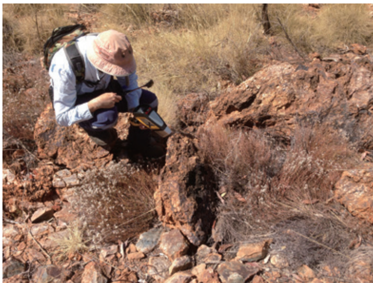
圖9：Enterprise靶區，含鐵露頭及銅草。中科礦業地質師在實地勘察過程中使用便攜式X射線光譜儀對元素進行初步分析。
