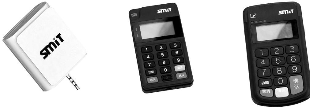
自二零一三年七月起，我們開始開發及銷售mPOS產品，以進軍中國不斷增長的基於硬件的移動支付市場，並通過發揮我們在為安全裝置行業設計及開發安全芯片方面的專長多元化及擴大我們的業務。mPOS產品是可與智能設備（如智能手機及平板電腦）連接的讀卡機，讓有關智能設備可處理付款交易，功能與移動收銀機一樣。mPOS產品可安全讀取信用卡及借記卡內的信息，執行與更大型及一般更為昂貴的固定POS終端機類似的功能。我們提供兩種形式的mPOS機－能夠通過藍牙連接的手持鍵盤設備及能夠直接插入智能設備的較小型無鍵盤模塊。我們至今已設計三款mPOS機，並與手機支付技術的發展同步進行更新，以增強安全性及兼容性。
