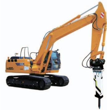
土方設備 — 挖掘機連附屬設備
