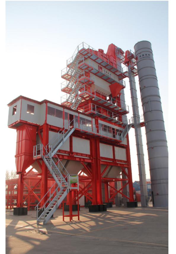
DG5000 瀝青混合料攪拌設備
