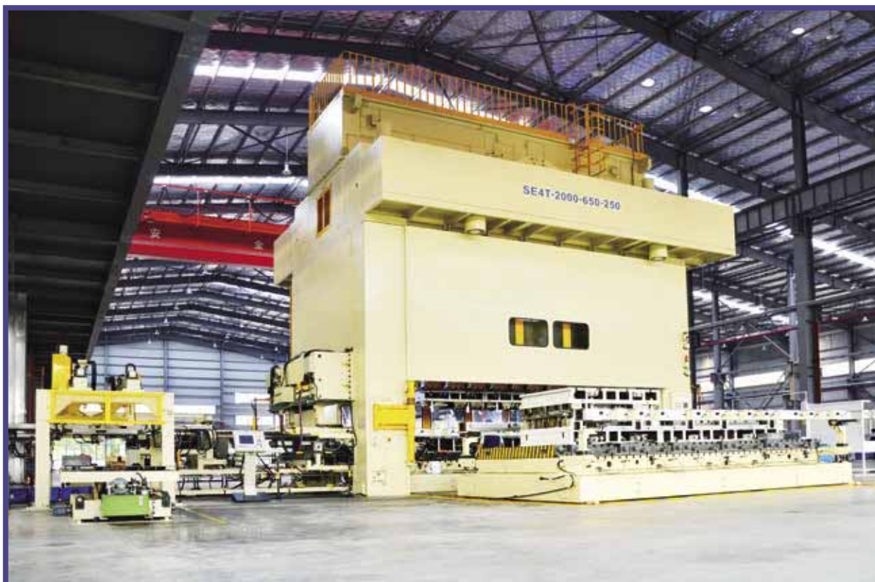
位於數碼模廣東(中山)汽車產業園之2,000噸汽車零部件沖壓機
